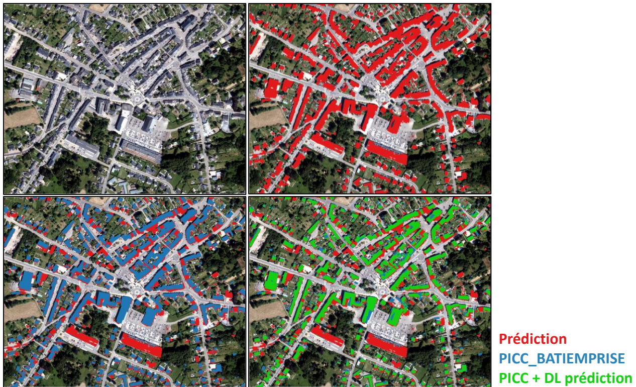
Figure 6 : détection des bâtiments en Wallonie via l'approche en deep learning, en haut à g. orthophoto 2018, en haut à dr. prédiction des bâtiments via le deep learning en rouge, en bas à g. surimposition en bleu de la donnée BATIEMPRISE du PICC, en bas à dr. bâtiments communs entre le PICC_BATIEMPRISE et la prédiction du deep learning en vert.
