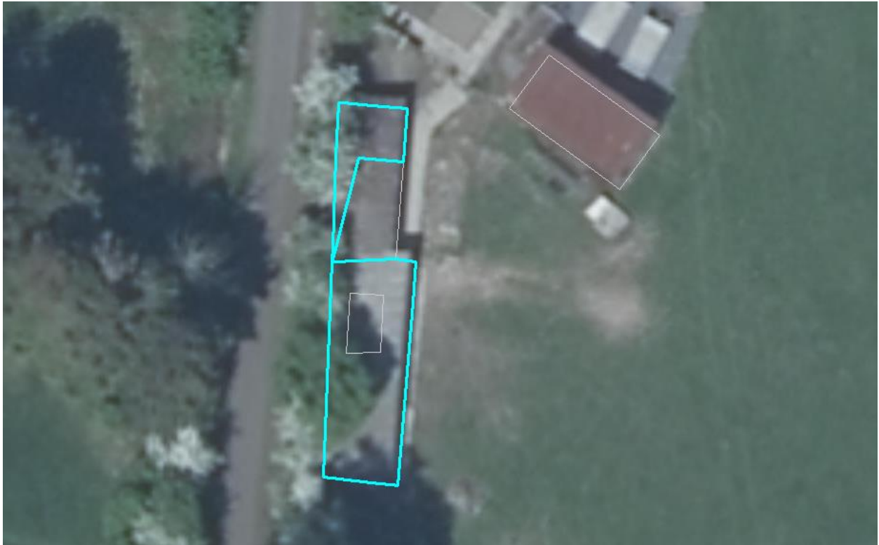
Figure 70 – Capture d'écran provenant du logiciel ArcGIS montrant un bâtiment possédant une géométrie multi-parties (+ cas de chevauchement entre bâtiments).
