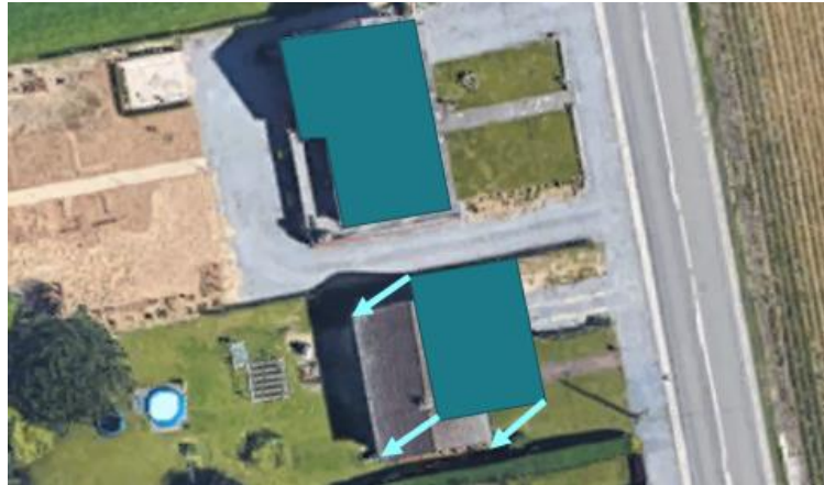
Figure 14 – Exemple d'erreur de positionnement absolu
