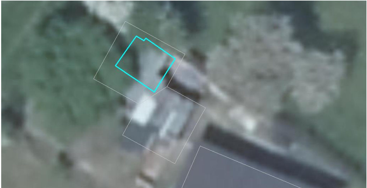
Figure 71 – Capture d'écran provenant du logiciel ArcGIS montrant un bâtiment totalement inclus dans un autre bâtiment.
