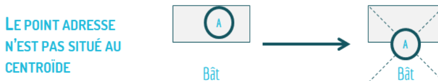
Figure 15 – Exemple d'erreur de positionnement relatif
