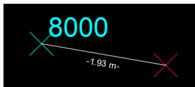
Figure 64 – Mesure de l'écart entre le point 8000 gps (en rouge) et son homologue local recalé (en bleu) en centimètres
