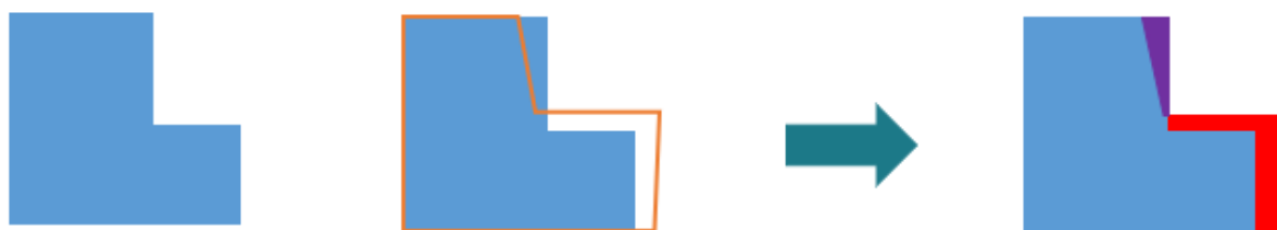
Figure 32 – Polygones parasites résultants de la superposition deux polygones homologues non-identiques.
