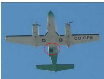
Figure 1: Avion "percé" pour que le capteur LiDAR puisse envoyer des ondes
