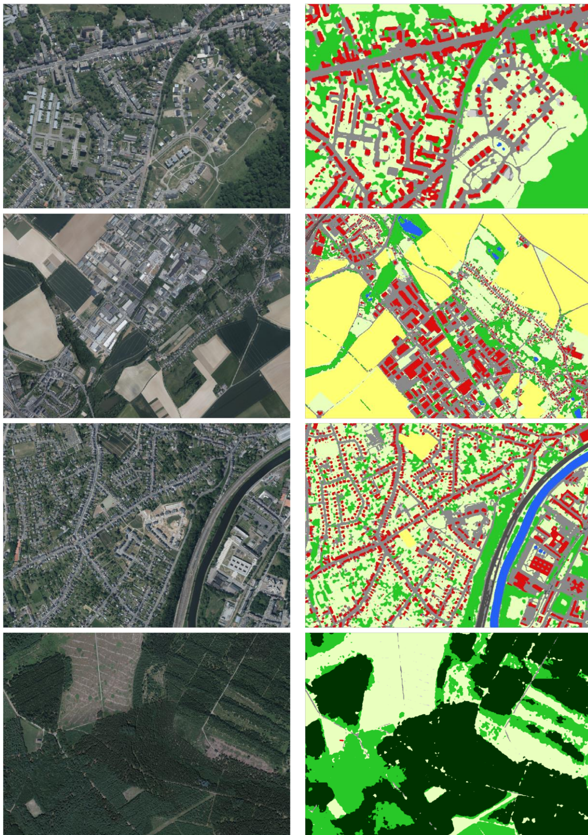
Figure 5: À gauche, une image satellite en RGB ; à droite, sa version segmentée selon les classes d'occupation du sol.
