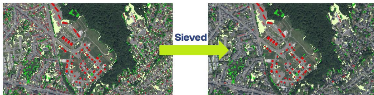
Figure 9: Application du filtrage sieved permettant de supprimer la majorité des effets de bord et des petites imperfections de prédiction.
