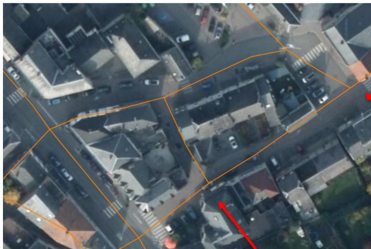
Figure 6 : exemple du manque de précision de la base de données OSM (en orange) pour les axes des routes.
